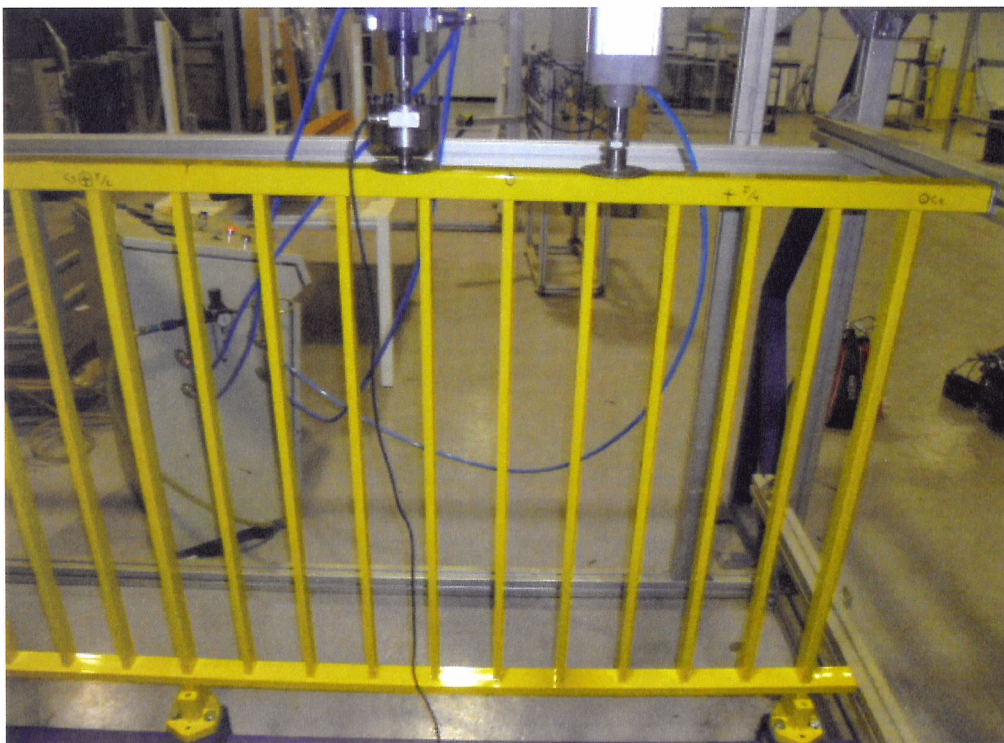
A.II-4: Ensayo de carga vertical
