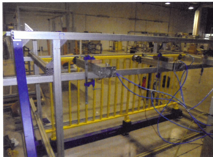
A.II-2: Ensayo de carga hacia el exterior
